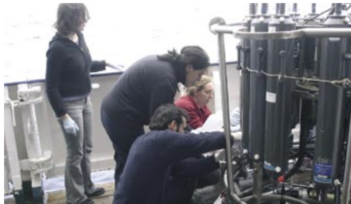
Probennahme an Bord von FS METEOR auf Reise M71-3, Februar 2007. Rechts: Rosette mit CTD und Flaschen Taking samples onboard RV METEOR during cruise M71-3, February 2007. On the right: Carousel with CTD and bottles.
